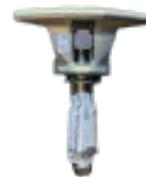
Morsetto per springbox sciovie, compatibile con i riferimenti originali LST. Questo morsetto per sciovie in acciaio è dotato di una ganascia mobile e di una ganascia fissa per una fune di 12 mm di diametro. Il morsetto per skilift tipo A è venduto senza molla.
