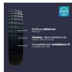
Il **PNEUMATICO STRIE RF TIPO LP 110/100 X 10 6PLY 5 BARS/72PSI TUBELESS** per installazioni LP è progettato per garantire una **massima aderenza**. Grazie a un nuovo **disegno a rilievo** del battistrada, si adatta perfettamente alle **traverse** delle stazioni di risalita, risolvendo efficacemente i problemi di **slittamento**. Questo pneumatico garantisce una trazione massima, assicurando prestazioni stabili e sicure anche negli ambienti più difficili.
