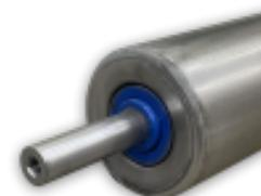
Rullo di linea per tapis roulant da sci. Progettato per nastri larghi 1200 mm. Informazioni aggiuntive : Larghezza del rullo: 1200 mm Larghezza totale: 1350 mm Diametro: 89 mm Posizione: Superiore
