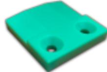
Guida pe laterale inferiore per tapis roulant MEB. Realizzato in polietilene per garantire una durata ottimale del prodotto. Dimensioni Lunghezza: 70 mm Larghezza: 70 mm Altezza: 12 mm Fori svasati: 2 (diametro 9 mm ciascuno) Disegno del prodotto disponibile su richiesta.
