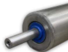
Rouleau de ligne pour tapis roulant skieurs. Conçu pour des tapis de 1200 mm de large. Informations complémentaires : Largeur du rouleau : 1140 mm Largeur hors tout : 1350 mm Diamètre : 60 mm Position : Supérieure
