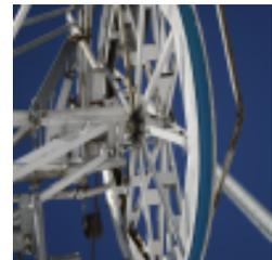
Bandage de poulie / Profil de poulie PU246 pour télési. Se monte en lieu et place de la référence d'origine. En polyuréthane renforcé afin d'assurer une durée de vie optimale dans des cas de températures extrêmes et d'utilisation intensive.
