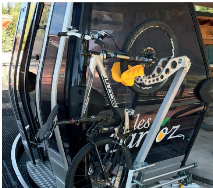
Le CAB RACK a été conçu pour transporter en toute sécurité 2 VTT sur des cabines. Les VTT sont disposés sur les faces amont et aval des cabines. La structure porteuse est composée d'un berceau venant se fixer sous la cabine. 2 racks (amont et aval) rapidement démontables assurent le maintien du VTT.
