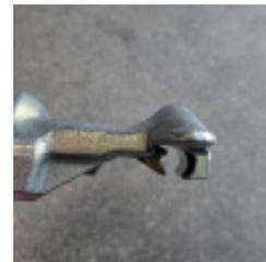
Klemme für Skilifte mit Aufwickelvorrichtung, kompatibel mit den Original-LST-Referenzen. Diese Skiliftklemme aus Stahl besteht aus einer beweglichen und einer festen Backe für Kabel mit einem Durchmesser von 22 mm. Skiliftklemme des Typs BC wird ohne Feder verkauft.
