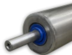
Linienrolle für Skifahrerlaufbänder. Zusätzliche Informationen : Breite der Rolle: 625 mm Breite über alles: 656 mm Durchmesser: 60 mm Position: Unterer
