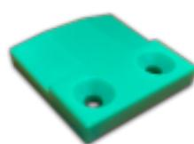
Untere seitliche pe-führung für MEB. Aus Polyethylen, um eine optimale Lebensdauer des Produkts zu gewährleisten. Abmessungen Länge: 70 mm. Breite: 70 mm Höhe: 12 mm. Senkbohrungen: 2 (Durchmesser jeweils 9 mm). Produktzeichnung auf Anfrage erhältlich.
