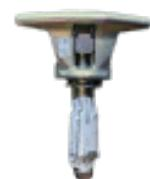
Klemme für Skilifte mit Aufwickelvorrichtung, kompatibel mit den Original-LST-Referenzen. Diese Skiliftklemme aus Stahl besteht aus einer beweglichen und einer festen Backe für Kabel mit einem Durchmesser von 16 mm. Skiliftklemme des Typs A wird ohne Feder verkauft.
