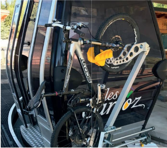
Das CAB RACK wurde für den sicheren Transport von 2 Mountainbikes auf Kabine konzipiert. Die Mountainbikes sind an der Vorder- und Rückseite der Kabine angeordnet. Die Tragstruktur besteht aus einer metallischen Wiege, die unter der Kabine befestigt werden kann. 2 schnell demontierbare Gestelle (vor und rück) sorgen für die Halterung des Mountainbikes.
